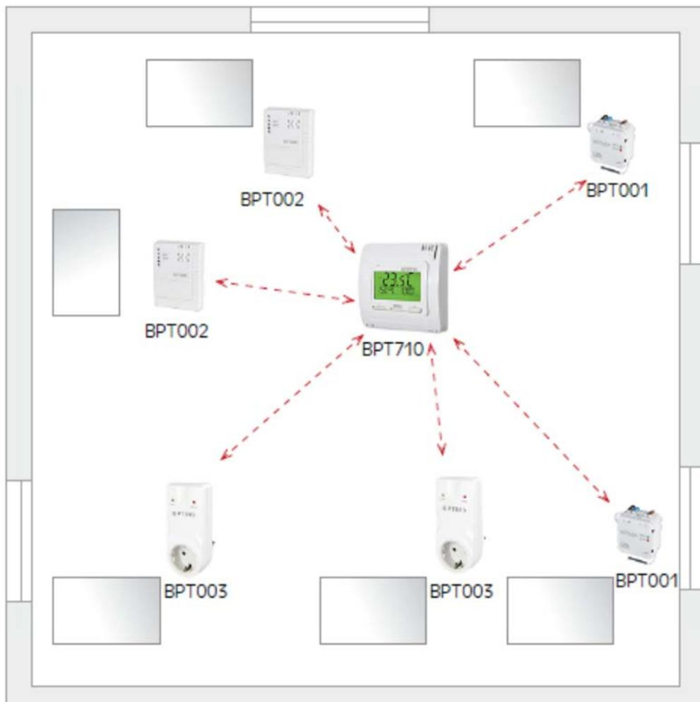
**Título:** Termostato calefacción esquema instalación System BPT
